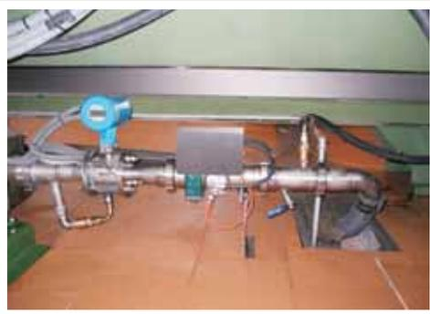
Este Sistema de Regulación de Humedad de la Pasta de Aceituna, se presenta como Solución a la regulación, corrección y estabilización, de forma continua, a tiempo real y en línea de proceso de la humedad de la masa de aceituna entrante al decanter, sin intervención de operarios.
