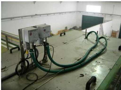
Este Sistema de Control y Regulación de la Humedad de la Pasta de Aceituna en Batidora es la Solución al control automático, sin intervención de operarios, de la adición de coadyuvantes tecnológicos (agua, talco,...) a la pasta de aceituna en la batidora, conforme a sus necesidades reales según su humedad.
