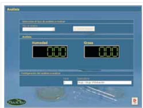
El **Software de Control y Gestión de Muestras Analizadas** es una herramienta de gran utilidad para el operario de almazara, por su fácil manejo y porque permite facilitar enormemente el control y configuración del mismo, a nivel de modo de análisis, definición de parámetros de calibración, iniciar función de análisis de muestra en el momento deseado por el usuario y almacenamiento automático de valores analíticos en una base de datos generada directamente por el propio programa.
